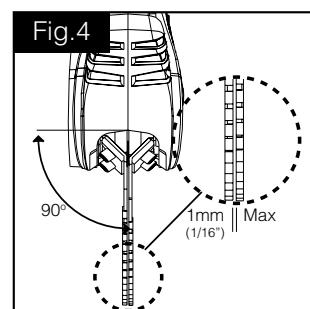
desmontarse y curvarse suavemente hacia dentro para ajustar la apertura.
