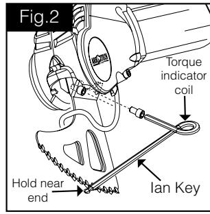
Vælg de ønskede blade til skære opgaven, og monter hver med deres dæksel skruer og spændskiverne. Vær sikker på at overfladerne på blad monterings underlaget, plejlstang gevind og skruerne er rene og uden murstøv og smøremiddel af enhver art før de samles. • Se efter om beskyttelses stangen kan lukkes før bladene samles med plejlstangen. Se fig. 2
