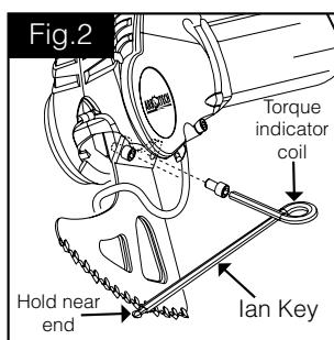
Kies de juiste zaagbladen voor het zaagwerk en bevestig deze met de bijbehorende kapschroeven. Zorg dat de oppervlakken van de zaagbladen, de schroefdraden van de aandrijfstang en schroeven schoon en zandvrij zijn en vrij van welk smeermiddel dan ook, voordat ze worden gemonteerd. Zorg dat de beschermkap kan worden gesloten voordat u de zaagbladen aan de aandrijfstang bevestigt (zie fig. 2).
