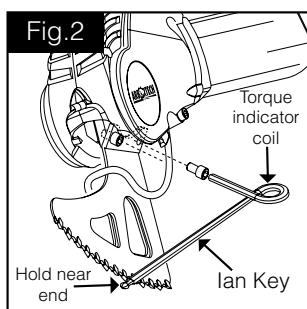
Seleccione las cuchillas adecuadas para el material a cortar y móntelas junto con sus tornillos de cabeza Allen. Compruebe que la superficie de los portacuchillas, la rosca de la biela y los tornillos estén limpios y sin lubricantes, antes de instalarlas. Asegúrese de que el protector pueda cerrarse antes de fijar las cuchillas a la biela.(véase la Fig. 2).
