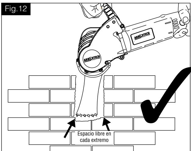
Cuando se utilicen cuchillas Émbolo para Argamasa, el corte debe tener suficiente espacio libre en cada extremo (como se muestra en la Fig. 12) para evitar el martilleo de los extremos de la cuchilla (como se muestra en la Fig. 13).
