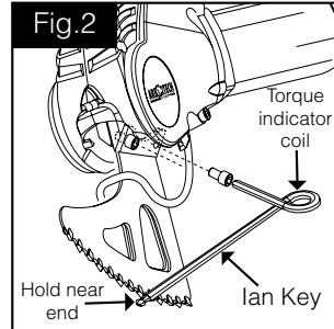
Choisissez les lames adaptées à votre coupe et montez-les, ainsi que les vis et les rondelles. Assurez-vous que la surface des supports de lame, les bielles et les vis sont propres, exempts de lubrifiant ou de tout autre produit susceptible de les endommager. Vérifiez que la garde peut être refermée avant de fixer les lames à la bielle (voir figure 2).
