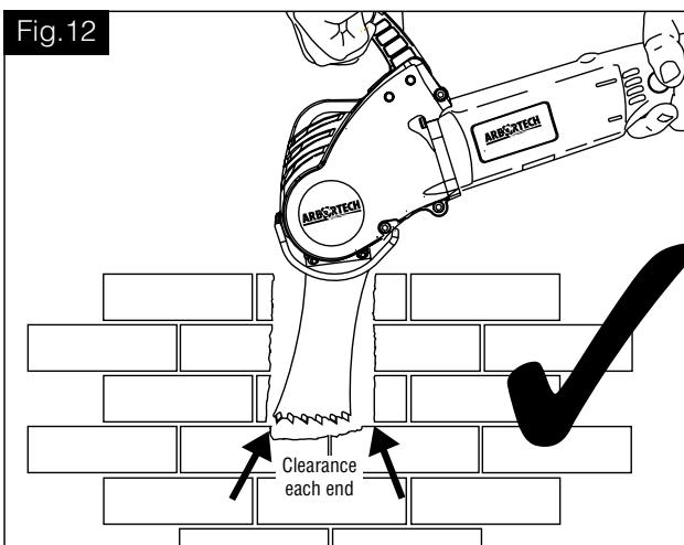
Når man anvender mørTEL dyk bladet, skal hullet være stort nok og der skal være luft i hver side (vist fig. 12) for at sikre at bladet ikke hamrer. (som vist fig. 13)
