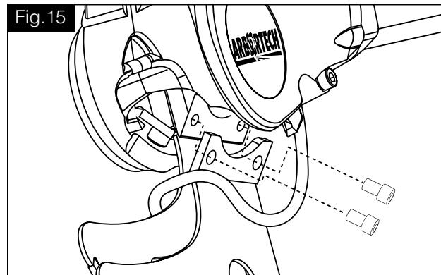
**VOORZICHTIG:** Het gereedschap mag NIET worden bediend als de zaagbladen los zitten. Als de zaagbladen los komen te zitten tijdens het bedienen van het apparaat, kunnen bevestiging en schroefdraden van het apparaat beschadigd raken.
