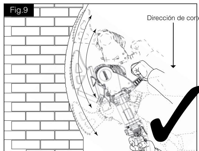
**PRECAUCIÓN:** La parte delantera y trasera de las cuchillas no deben martillear contra superficies duras (véanse las Fig. 10, 11 y 13) ya que dañarán las cuchillas y la herramienta. Si esto ocurre, desconecte la herramienta inmediatamente o extráigala del corte.
