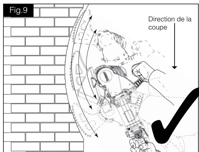
**ATTENTION :** Le martelage des extrémités des lames sur une surface dure peut les endommager, ainsi que l'appareil (voir figures 10, 11 et 13). En cas de martelage accidentel, arrêtez l'appareil ou ôtez-le immédiatement de la coupe.
