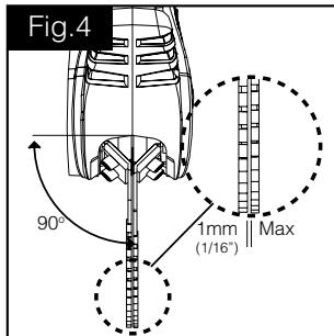
Si l'espace entre les lames est trop important, comme après plusieurs utilisations, les lames peuvent être retirées et pliées doucement vers l'intérieur afin de réduire l'espace. Assurez-vous que les deux lames sont alignées verticalement à l'appareil (voir figure 4).
