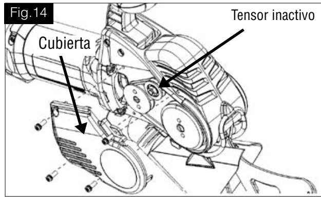
Si hay resbale excesivo, se pueden gastar las poleas. Una polea gastada se nota cuando la ranura ha perdido su bien definida forma de V, resultando una ranura redondeada o plana. Para reemplazar cualquiera de las poleas, póngase en contacto con su servicentro autorizado de ARBORTECH.
