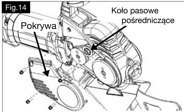
Nadmierny poślizg może prowadzić do zużycia koła pasowego. Zużyte koło pasowe można poznać po tym, że rowek nie ma prawidłowego profilu „V“, lecz jest zaokrąglony lub spłaszczony. Celem wymiany koła pasowego prosimy skontaktować się z najbliższym autoryzowanym serwisem ARBORTECH.
