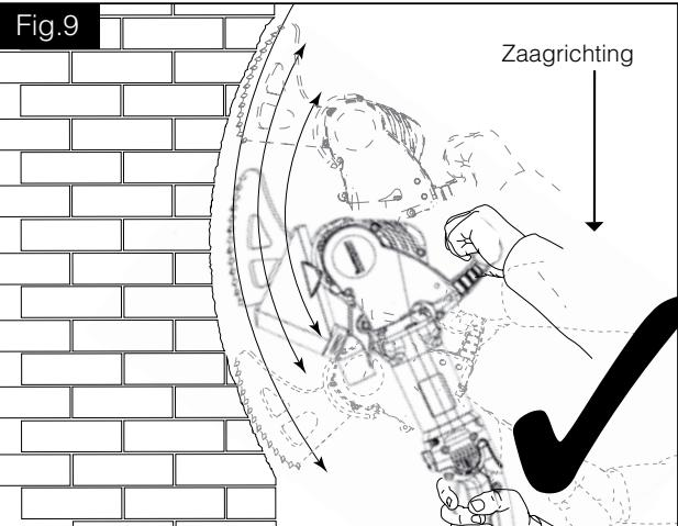
**VOORZICHTIG:** Zorg dat de voor- of achterkant van de zaagbladen niet op harde oppervlakken hamert (zoals in fig. 10, 11 en 13), omdat dit de zaagbladen en het apparaat beschadigt. Als er toch onopzettelijk hamerende bewegingen worden gemaakt, stop dan het apparaat of haal de zaag direct uit de zaagsnede.
