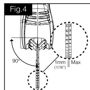
Als de ruimte tussen de zaagbladen te groot is, kunnen ze worden losgemaakt en voorzichtig naar binnen worden gebogen en zo worden aangepast aan de opening. Zorg dat beide zaagbladen verticaal worden uitgelijnd ten opzichte van het apparaat (zie fig. 4).
