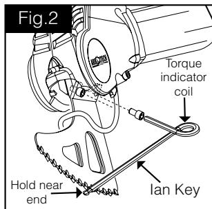
Die richtigen Klingen für das Schneidmaterial auswählen und zusammen mit ihren Kopfschrauben montieren. Stellen Sie vor der Zusammenführung der Klingen sicher, dass die Oberflächen der Klingenaufsätze, das Pleuelgewinde und die Schrauben sauber und schmutzfrei bzw. frei von jeglichen Schmiermitteln sind, und dass der Schutzbügel vor Befestigen der Klingen am Pleuel zugemacht werden kann (Siehe Abb. 2).
