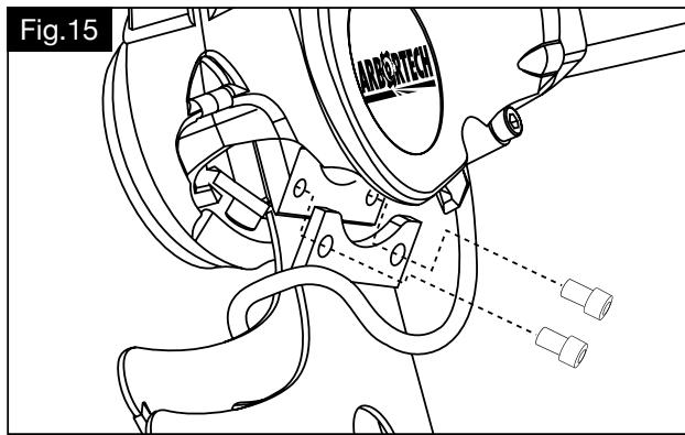
**UWAGA!**: Prosimy o dopilnowanie, aby elektronarzędzie nie było używane z poluzowanymi brzeszczotami. Jeśli podczas użytkowania brzeszczoty mają luz, to może to prowadzić do uszkodzenia mocowania brzeszczotów i gwintów, co prowadzi do znacznych kosztów naprawy.
