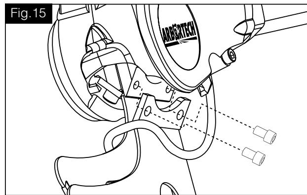
**ATTENTION:** N'UTILISEZ PAS l'outil si les lames sont lâches. Si les lames deviennent lâches en utilisant l'outil, les supports des lames et les filletages peuvent s'endommager et entraîneront de réparations conséquentes.
